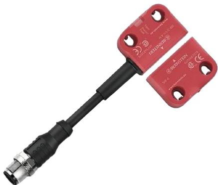
Sensores de segurança sem contato usam tecnologia RFID para gerar um sinal que determina se o transmissor e o receptor estão dentro do alcance um do outro – até 13 mm. Esses dispositivos são ideais para detectar se portas, portões, proteções ou painéis estão devidamente fechados, impedindo o acesso a áreas perigosas de uma máquina ou sistema.
