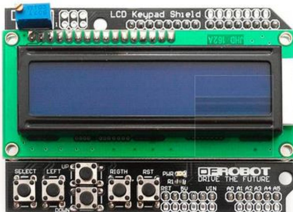
Este shield é especialmente útil para ser usado com a placa Arduino UNO pois já vem com 6 teclas que utilizam a entrada analógica A0 deixando livres as portas digitais!
