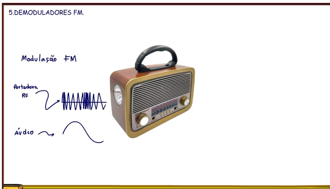
Durante a Transmissão em frequência modulado quem vai variar agora é a frequência da portadora, a amplitude vai se manter constante, isso garante um sinal modulado de melhor qualidade, praticamente imune às interferências eletromagnéticas.
