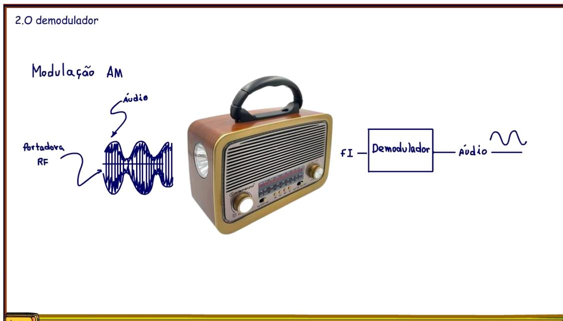
Logo após o estágio do amplificador de FI, existe o circuito chamado de demodulador ou detector, que terá a função de extrair o sinal de áudio que modula o sinal de radiofrequência, mas como as modulações FM e AM são muito diferentes os circuitos para demodulação também são muito diferentes.
