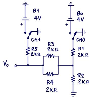
Você viu nesse tutorial como analisar um circuito do tipo R/2R uma associação de resistências muito usada nos conversores digitais analógicos, bom proveito.
