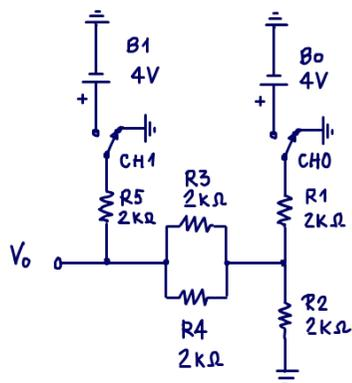
$V_0$  para CH0 ON! $V_0$  para CH1 ON!Para CH0=CH1 OFF  $\Rightarrow V_0=0V$
