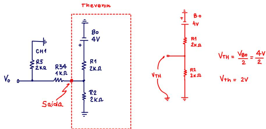
A tensão de Thevenin é a tensão sobre a resistência  $R_2$ , que é a resistência ligada ao terra.
