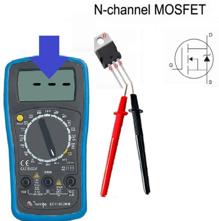
Isto é normal, uma resistência baixa indica MOSFET com falha!
