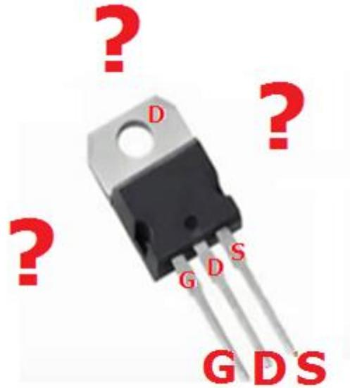
Observe que o DRENO tem conexão no terminal central e no dissipador!
