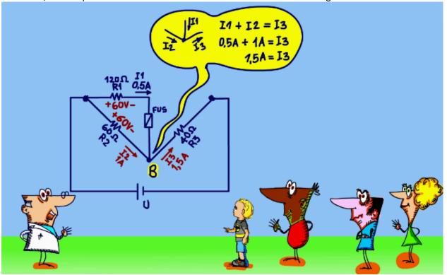
Agora usando a Lei de OHM vamos determinar a tensão sobre a resistência R3, escreva a tensão no diagrama.
