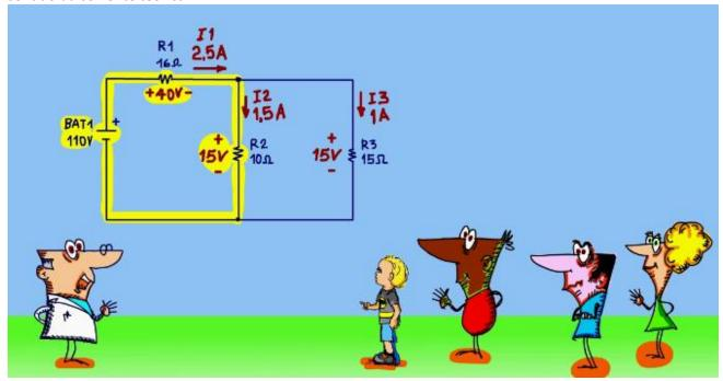
A tensão da fonte vamos chamar de VBAT1 estimado, é positivo porque a corrente da malha passa do negativo para o positivo.
