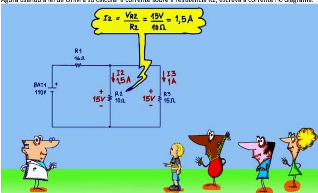
Agora usando a lei de OHM é só calcular a corrente sobre a resistência R2, escreva a corrente no diagrama.
