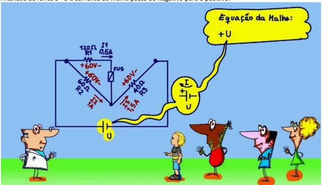
A tensão da resistência R2 é -60V, a corrente passa do positivo para o negativo.
