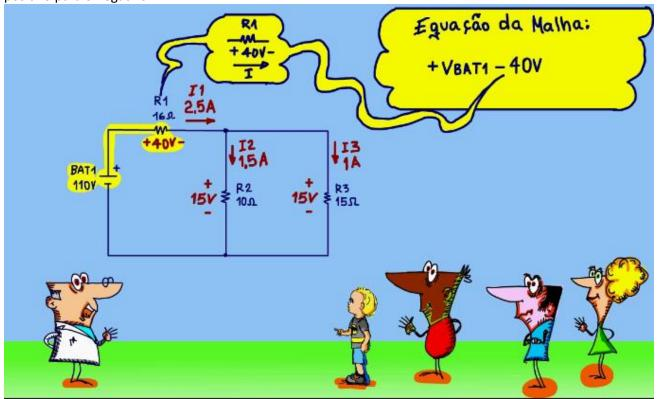
Seguindo vem a tensão sobre a resistência R2, o sinal será negativo porque a corrente da malha percorre a resistência do positivo para o negativo.
