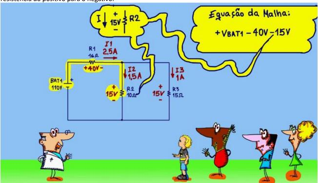
Agora iguale tudo a zero. Pronto esta e a equação, agora é só resolver! A tensão estimada da bateria é de 55V se a corrente I3 fosse de 1A, então é só dividir a tensão real pela tensão estimada para determinar o ERRO!
