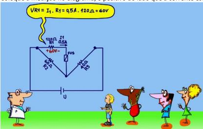
Como R1 está em paralelo com R2, então a tensão sobre a resistência R2 também é 60V e vamos colocar esta medição no diagrama.
