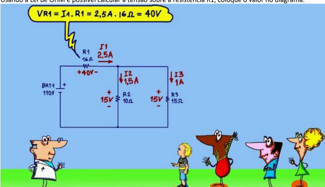
Usando a Lei de OHM é possível calcular a tensão sobre a resistência R1, coloque o valor no diagrama.
