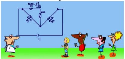
Primeiro a corrente I1 passa pela resistência R1, então usando a Lei de OHM vamos determinar a tensão sobre a resistência R1.
