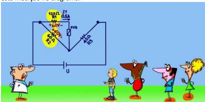
Agora é possível calcular a corrente na resistência R2 usando a Lei de OHM, coloque a corrente no circuito!
