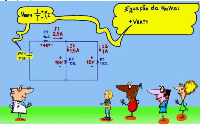
Depois vem a tensão de sobre R1 o sinal será negativo porque a corrente da malha percorre a resistência do positivo para o negativo.
