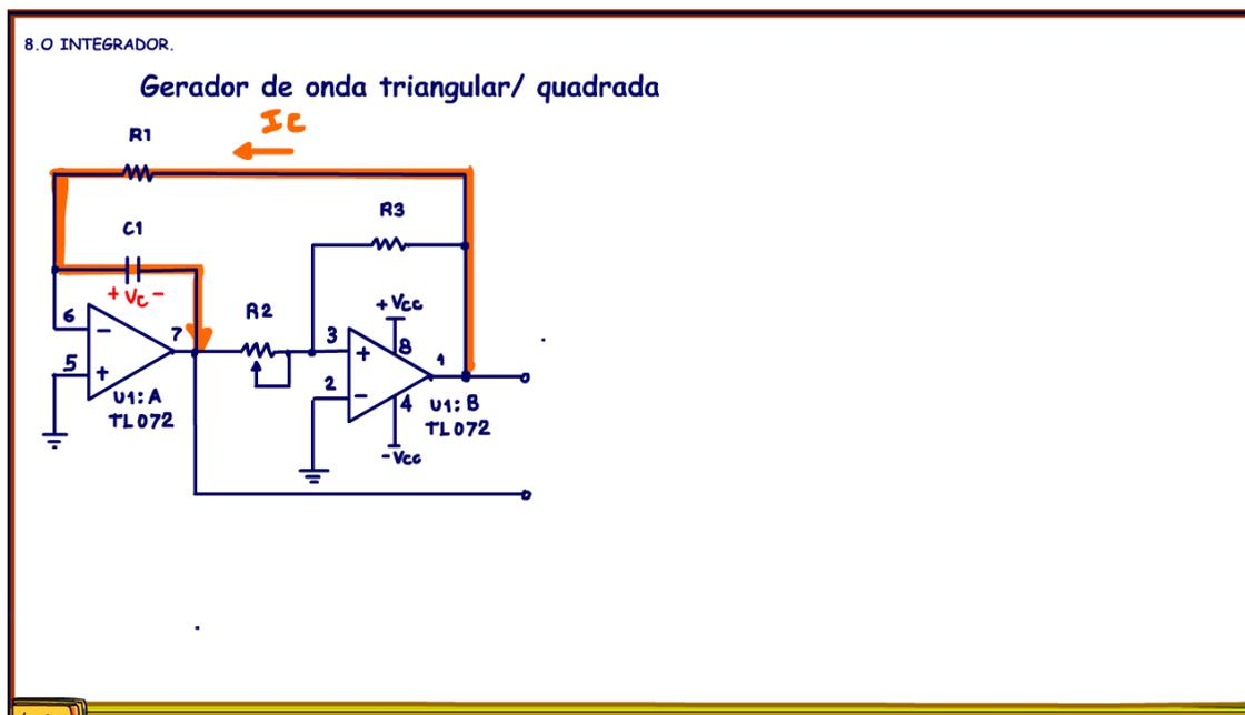
O circuito do operacional A é um integrador, o capacitor C1 é carregado e descarregado com uma corrente constante gerada pela saída VB e a resistência R1.
