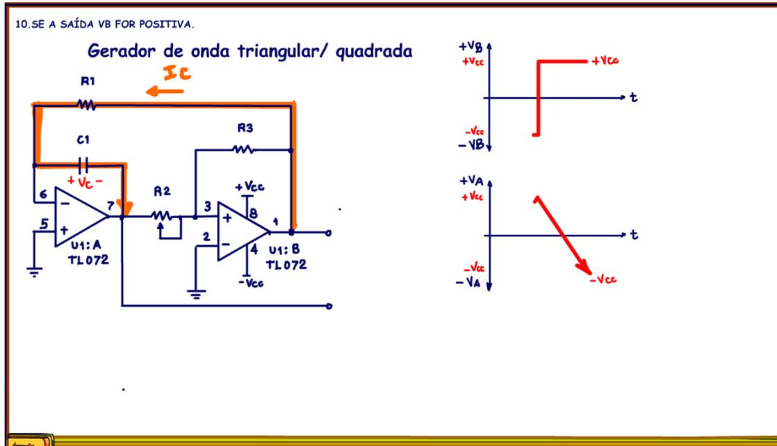
Se a saída VB inverter, for igual a  $+V_{CC}$ , então o capacitor vai se carregar de forma linear com a polaridade invertida, agora o negativo do capacitor fica para a saída VA e o capacitor vai se carregar em direção a máxima tensão negativa, a tensão igual  $-V_{CC}$ , ou  $-6V$  no nosso exemplo.
