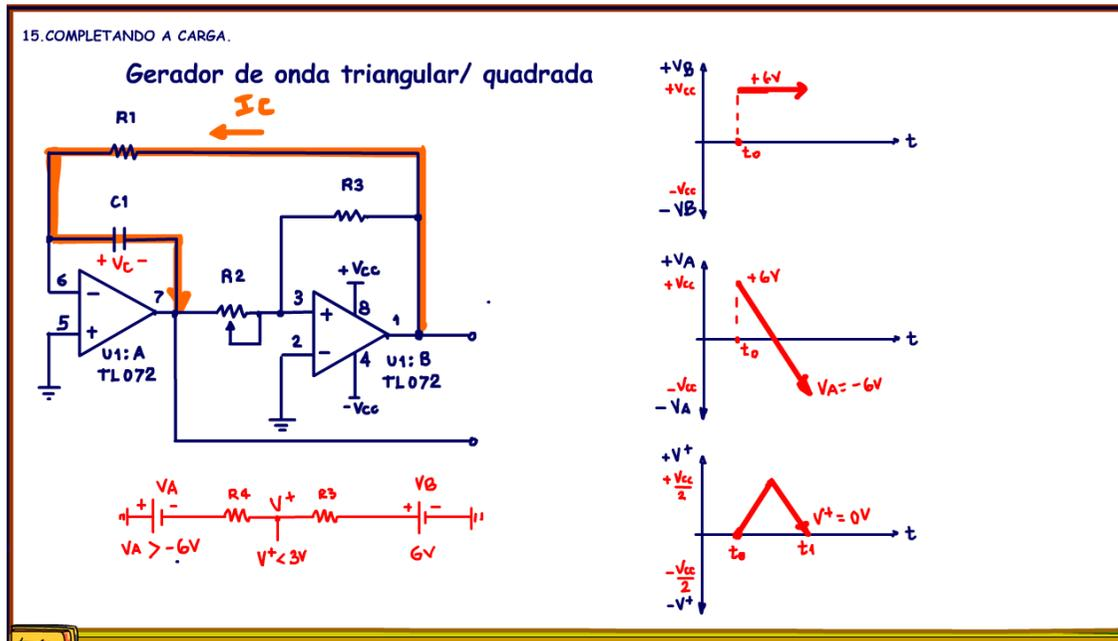
A partir desse ponto a tensão na saída VA começa a ficar negativa, ela vai direto em direção a tensão -6V, a tensão no ponto V+ agora começa a descer pois o negativo da saída VA começa a compensar o positivo da saída VB.
