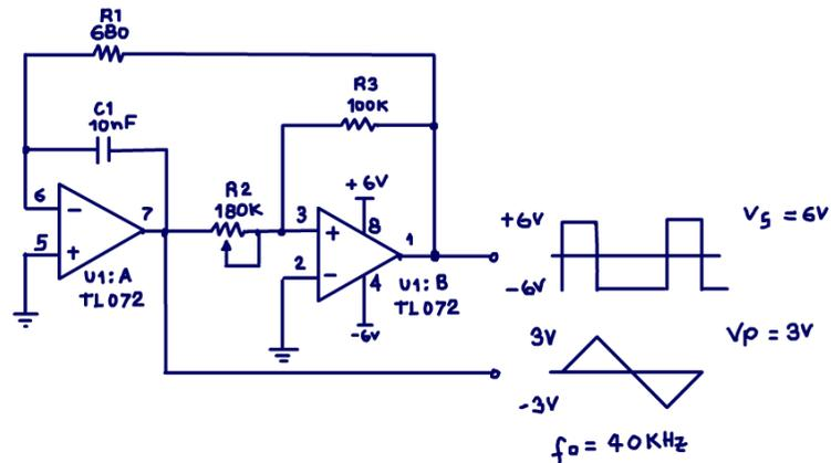
Eu montei e testei o circuito para 40 kHz, veja os valores na figura, esse circuito será útil para amplificadores Classe-D, a alimentação é simétrica de +6V e -6V, esse circuito gerou uma onda triangular perfeita.
