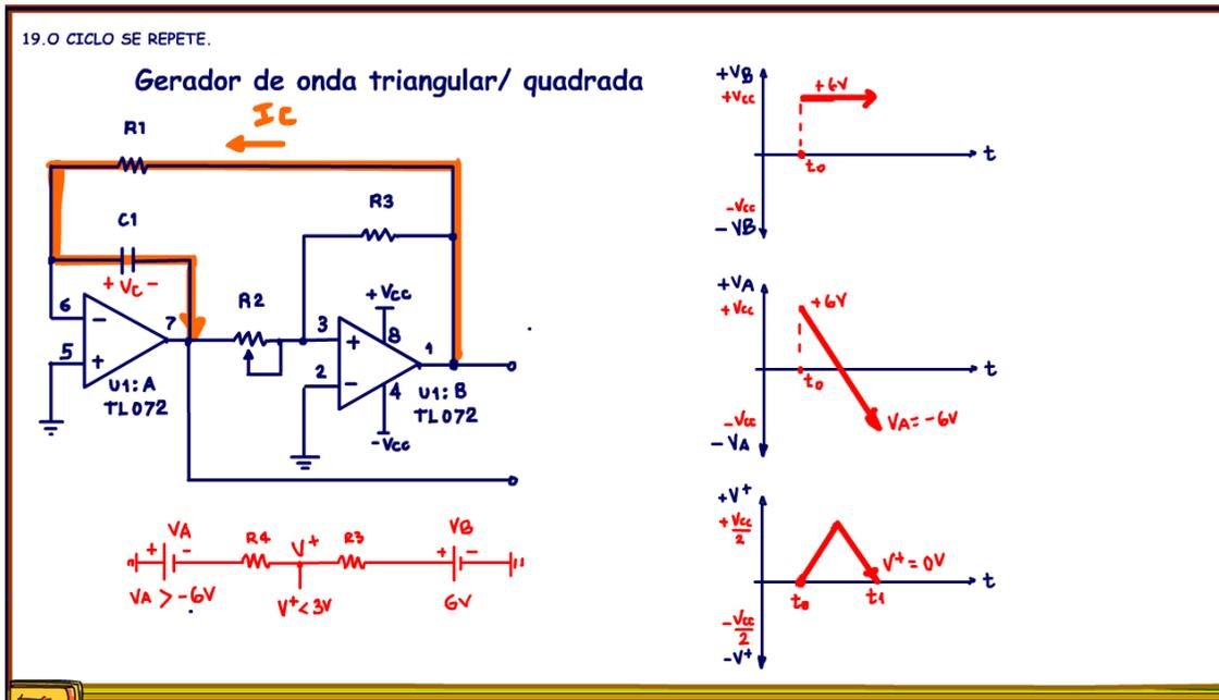
A partir daí o ciclo se repete e na saída VA aparece uma onda triangular e na saída VB uma onda quadrada.
