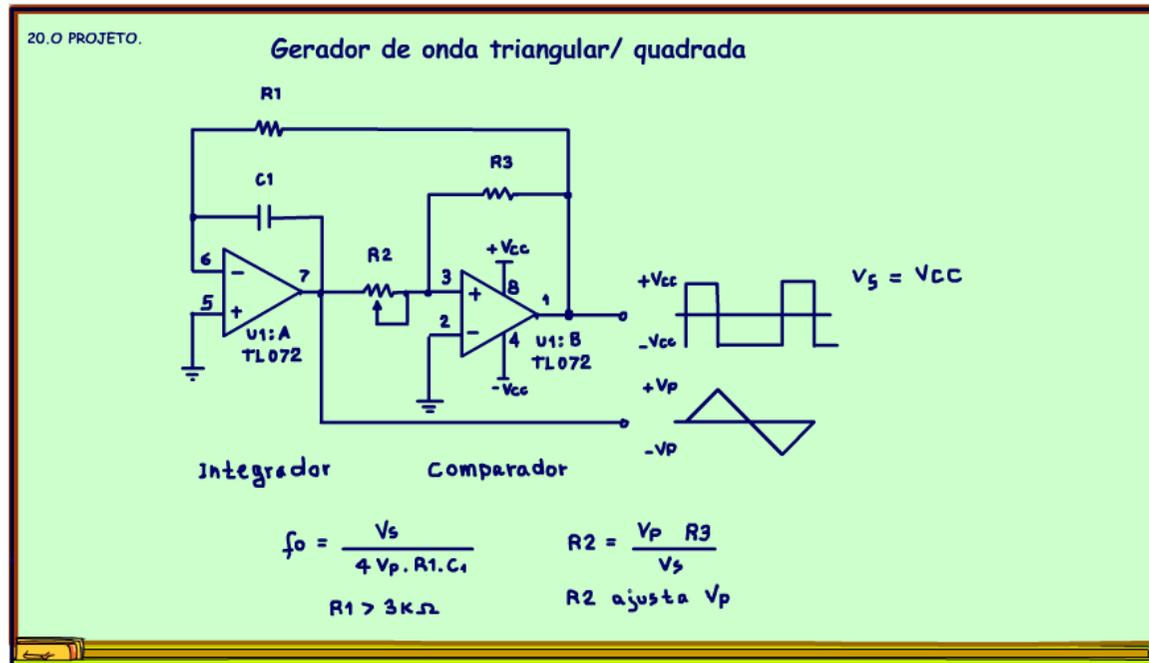
Na figura você encontra todas as equações, note o trimpote R2 serve para ajustar a amplitude da saída e disparar o circuito, então ao ligar gire o trimpote R2 até que a onda triangular apareça na saída, e aí será possível ajustar o nível máxima da saída, é o  $V_p$  da equação, essa tensão é próxima de VCC, mas vai depender do operacional.
