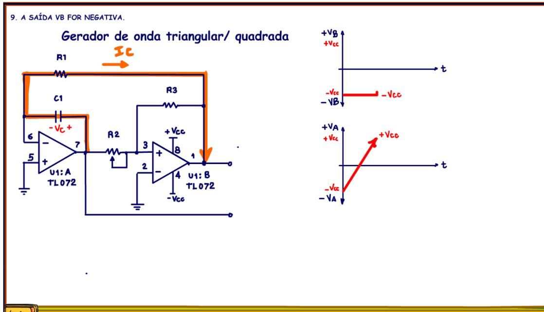
Nesse circuito quando a tensão  $V_B$  é negativa, a corrente circula entrando no operacional B, corrente negativa, essa corrente circula pelo capacitor e gera uma tensão no capacitor com o positivo para o lado da saída  $V_A$ , na verdade é operacional A que empurra essa corrente pelo capacitor para dentro do operacional B.
