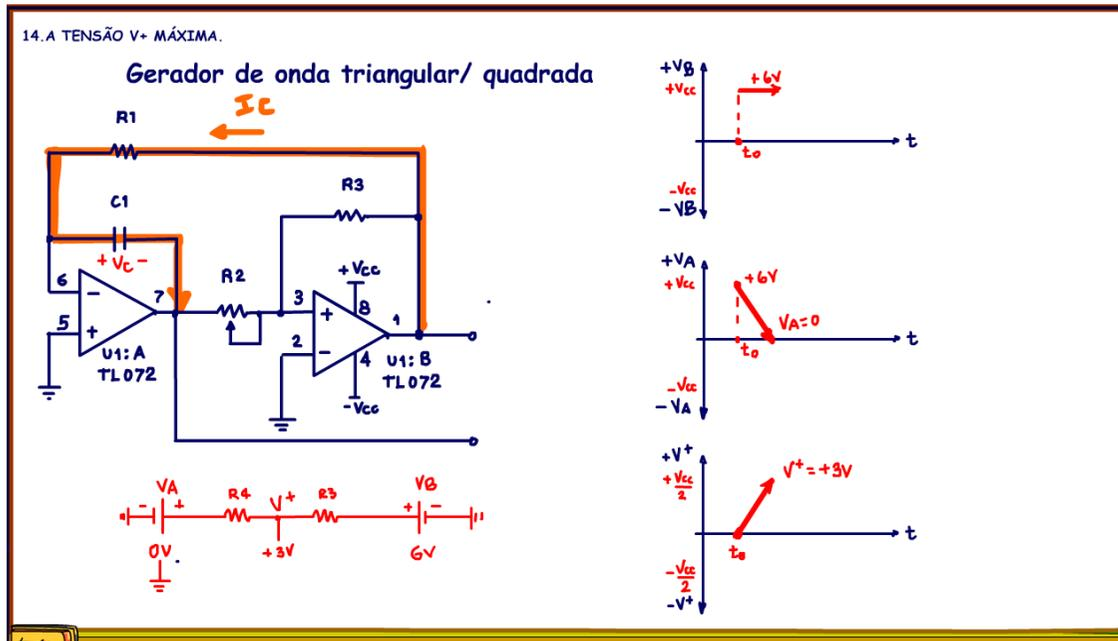
A tensão  $V_B$  vai descendo em direção ao  $-6V$ , tem um momento que ela passa pelo zero volt, isso equivale a aterrar a saída  $V_a$ , nessa condição a tensão  $V^+$  é exatamente igual a metade da tensão  $V_B$ ,  $+3V$ , essa é a máxima tensão positiva de  $V^+$ .
