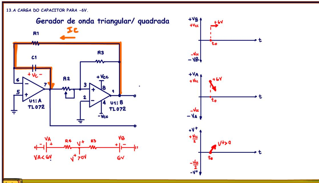
Agora o capacitor começa a carregar em direção a tensão máxima negativa, a tensão na saída  $V_A$  começa a ir na direção a  $-6V$ , mas a tensão na saída  $V_B$  continua firme em  $+6V$ , como  $V_A$  vai diminuindo a tensão no ponto  $V^+$  continua crescendo para o positivo, isso mantém a saída  $V_B$  no positivo,  $V^+$  é maior do que zero.
