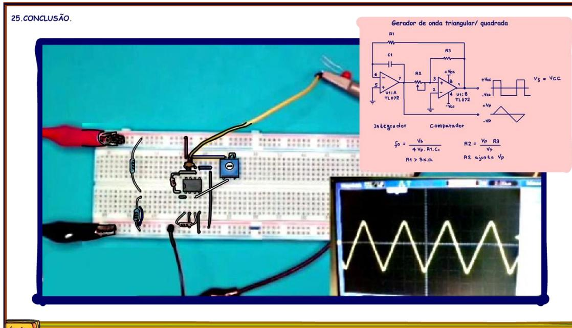
Você viu nesse tutorial a teoria e a prática para montar um gerador de onda triangular o pilar de um circuito gerador de PWM, bom proveito.
