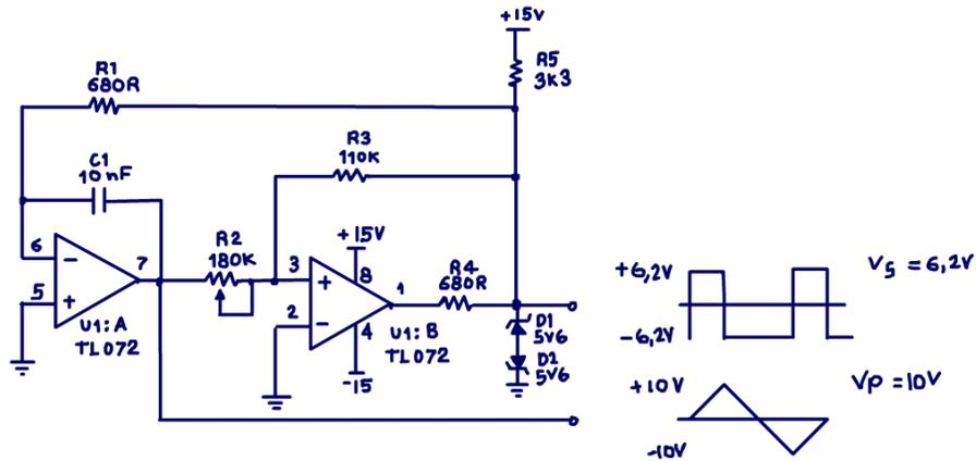
O circuito da figura pode ser usado com qualquer tensão de alimentação, os zeneres na saída fixam a tensão VP e VS independente da tensão de alimentação dos operacionais.
