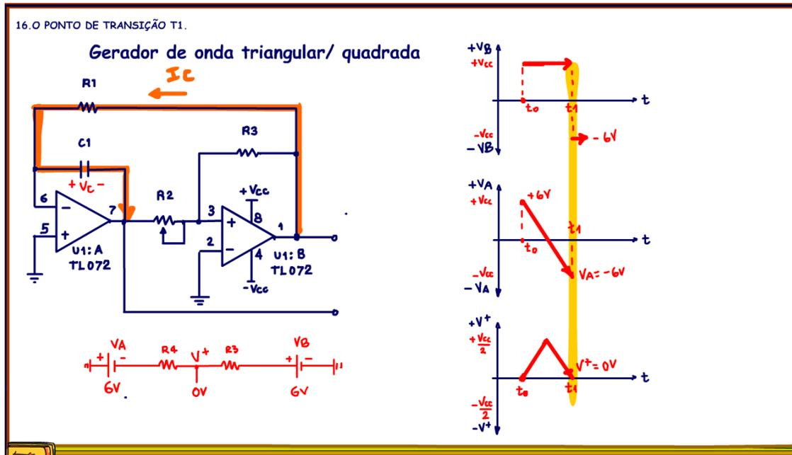
No tempo  $t_1$  a tensão na entrada  $V_A$  é oposta a tensão  $V_B$  e pronto temos novo ponto de transição a tensão na saída  $V_B$  troca de positivo para negativo.
