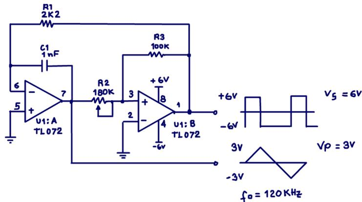
Esse é um circuito para altas frequências, esses são os valores para 120 kHz, podendo ser usado em um inversor com PWM ou até SPWM, a onda triangular é ponto fundamental para gerar o PWM e esse circuito funciona muito bem nessas aplicações.
