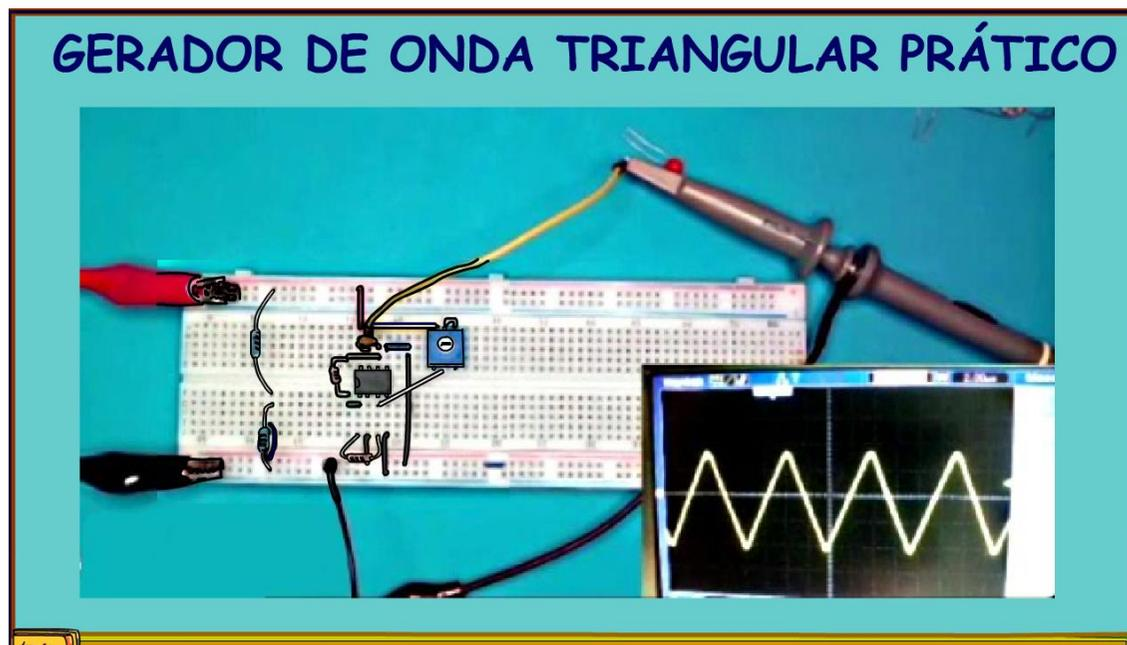
Nesse tutorial eu vou mostrar um circuito para gerar uma onda triangular muito simples, fácil de montar, o coração de qualquer PWM, inclusive o SPWM para construção de inversores ou amplificadores Classe-D, um circuito que funciona realmente mesmo em frequências da ordem de 60 kHz a 100 kHz.
