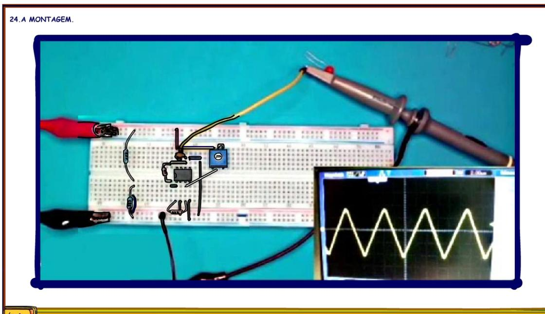
Vejam a montagem na protoboard e a imagem do osciloscópio mostrando a forma de onda, eu cheguei a montar um pequeno inversor usando esse gerador de onda triangular e funcionou muito bem, o que vocês acham da forma de onda?
