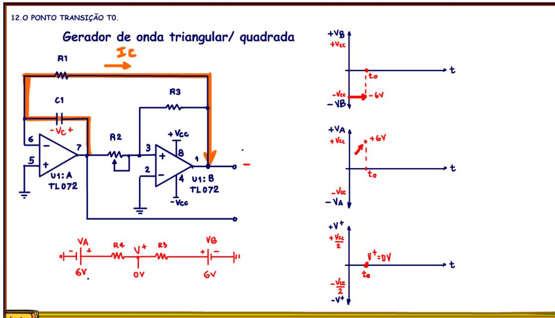
Vamos supor que a tensão na saída  $V_B$  é igual a máxima tensão negativa, para deixar mais didático, vou assumir a máxima tensão igual a  $-6V$ . O capacitor vai se carregar e a saída  $V_A$  vai para a máxima tensão positiva, bem no tempo  $t_0$  temos a condição da transição as duas tensões de mesmo valor, mas polaridades opostas, a tensão do ponto  $V^+$  para o terra será zero volt.
