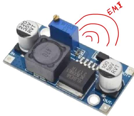
Como as frequências usadas são muito altas, tanto os indutores como os capacitores podem ser bem pequenos e o rendimento é muito alto, os transistores de chaveamento trabalhando saturado cortado não perdem energia na forma de calor.
